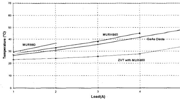
Fig. 8. Temperature of Rectifiers ( $V_o=400 V$ )
